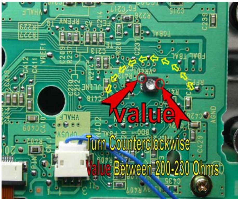
Tourner le potentiomètre dans le sens inverse des aiguilles d'une montre jusqu'à obtenir une valeur comprise entre 200 et 230 Ohms aux bornes de celui-ci. (indiqué par les flèches rouges)
